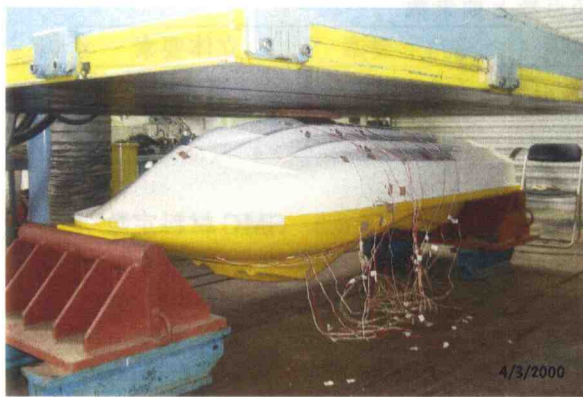
写真-3.3.2 実験状況 (縦曲げ試験)
