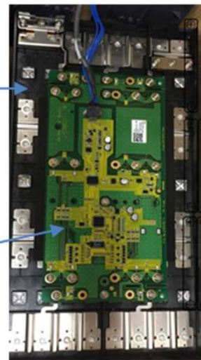
電池モジュール内部 写真(Top view)
