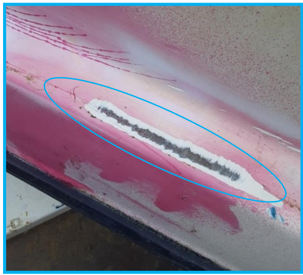
写真③ 写真②のカラーチェック後（積層内部までの割れを確認）
