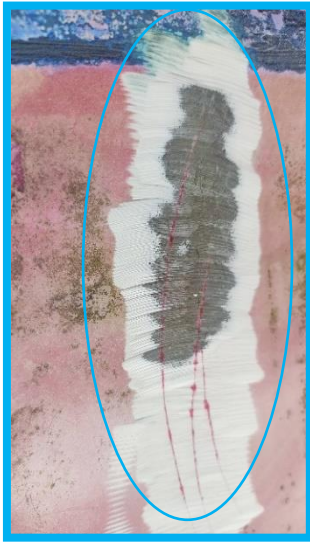
写真③ 写真②のカラーチェック後（積層内部までの割れを確認）
