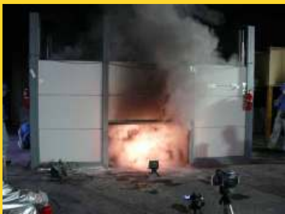
③自動拡散型消火器作動
