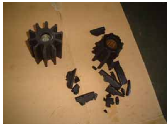
破損したインペラ
