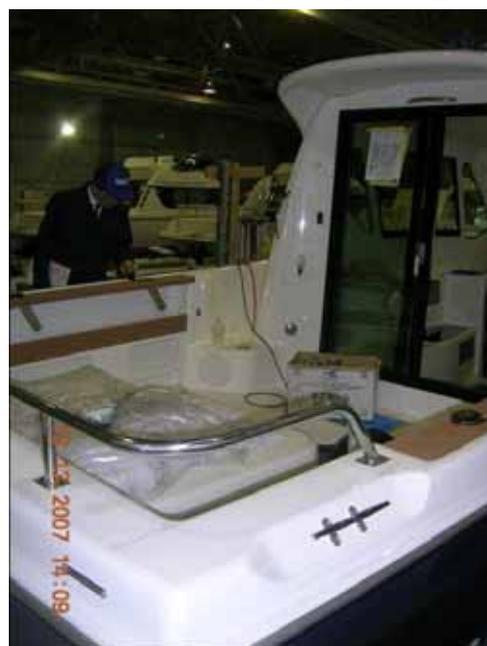
写真2 デッキ上構造物を載せた後
