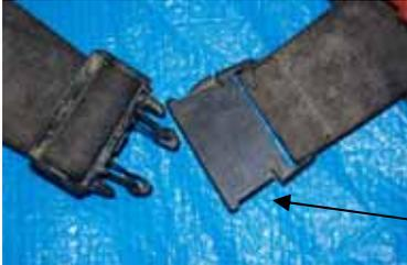
破損                                | バックルが外れて、救命胴衣が脱げる。                      |
