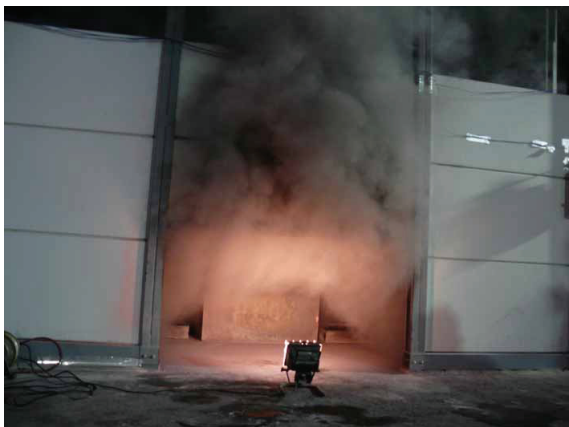
消火器起動後の確認（2分間）
