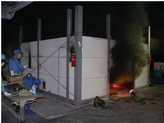
燃焼実験の様子(前部開口からの煙)
