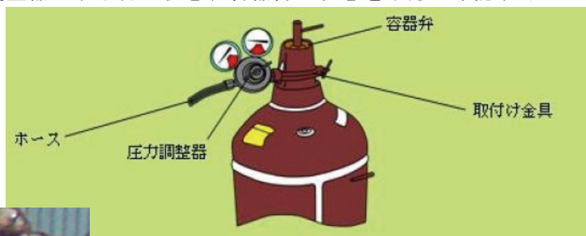
アセチレンガスボンベ
