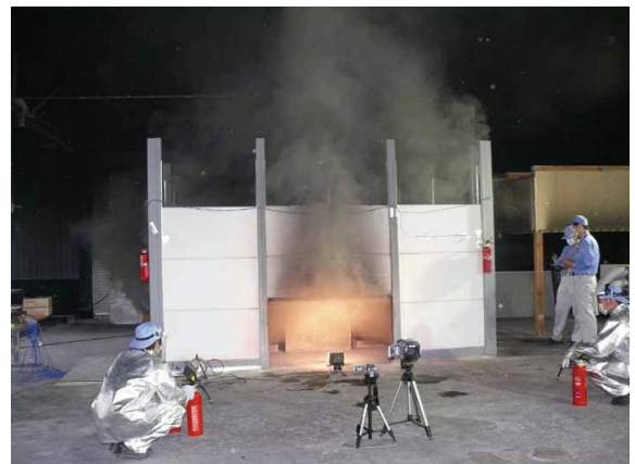
全ての火皿の消火を確認
