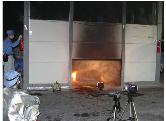
同時放出 (消火器手動起動)
