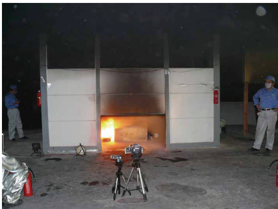
消火器起動後に火皿の不消火を確認
