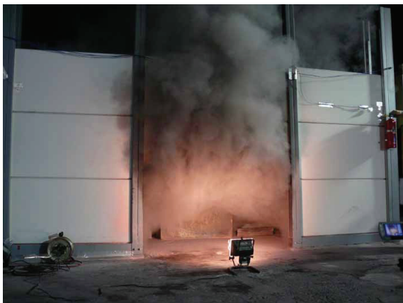
消火器起動後の火皿消火確認（2分間）
