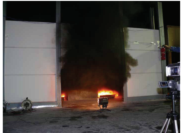
燃焼実験の様子(前部開口からの煙)
