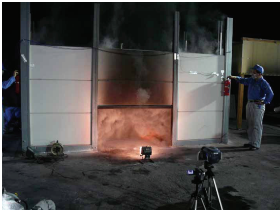
同時放出（消火器手動起動）
