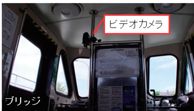
写真 3.2-8 ブリッジに設置したビデオカメラ
