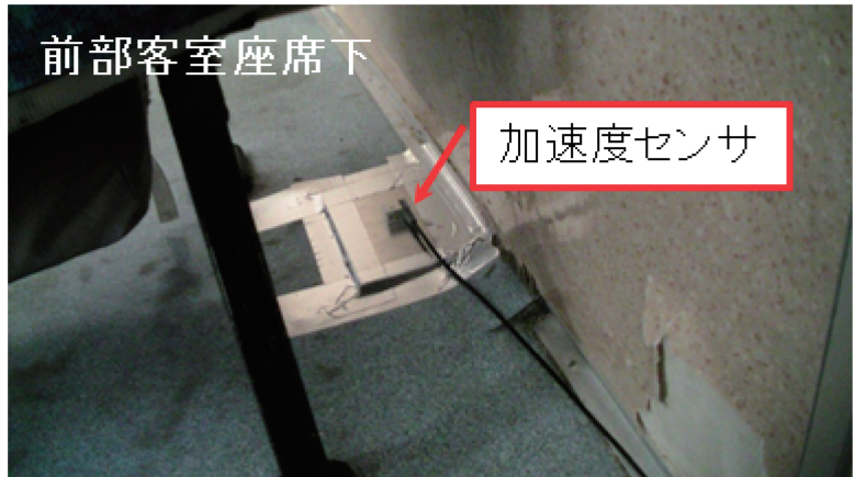
写真 3.2-4 前部客室座席下の加速度センサ
