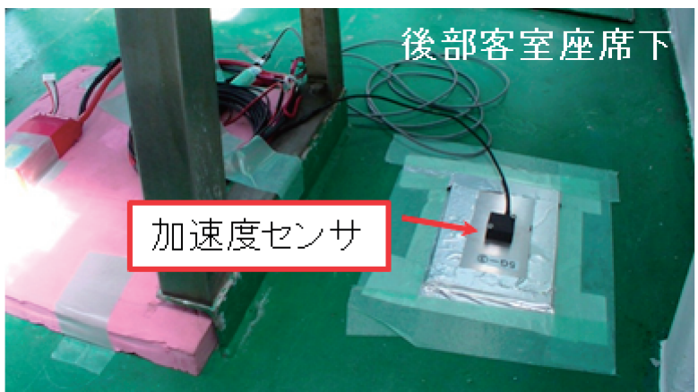
写真 3.2-6 後部客室座席下の加速度センサ
