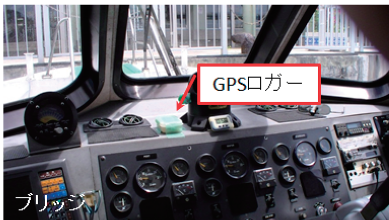
写真 3.2-7 ブリッジ計器盤上の GPS ロガー
