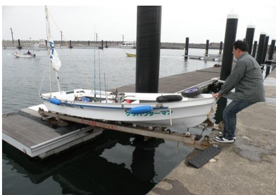
写真 3-2-1 棧橋を結ぶローラーで上げ下げする
