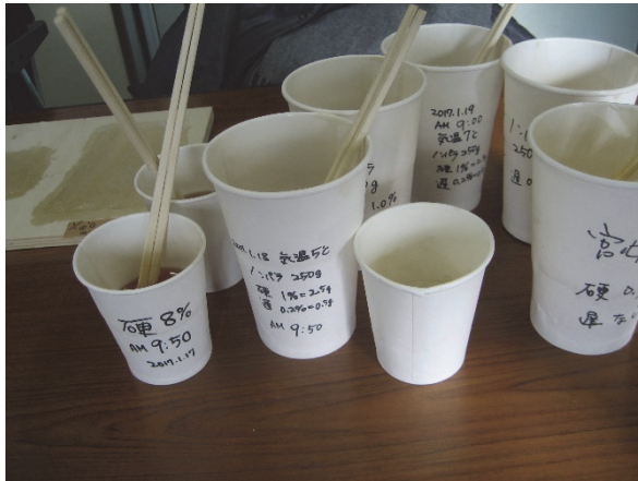
樹脂の硬化試験用検体（その１）
