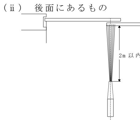
図2-1 検査個所と射水角度
