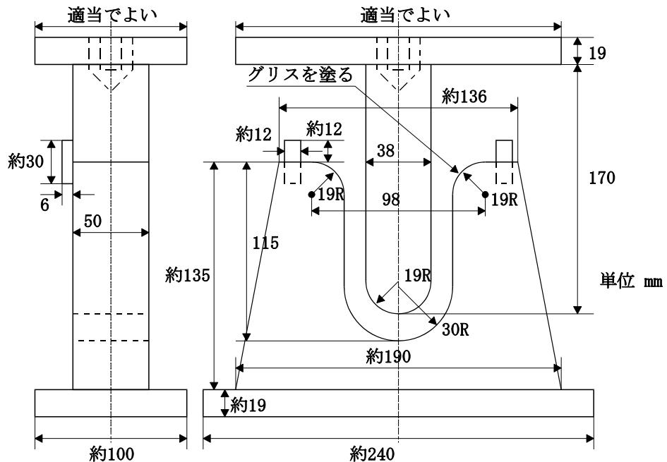
図3 形曲げ試験用治具
