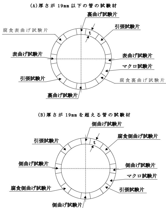
図 3 溶接部の引張試験片
