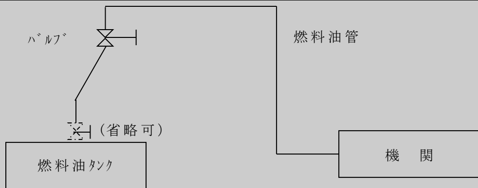
図35.3<3> 弁又はコックを燃料油タンク壁に連結させなくて良い場合 (e) タンクの頂部より低い位置に燃料油管が配置されない場合は、 弁又はコックを備え付けなくても差し支えない(図35.3<4>参照)。
