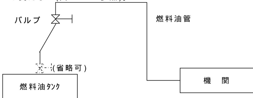
図35.3<3> 弁又はコックを燃料油タク壁に連結させなくてよい場合
