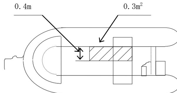
(ハ) 跨座席(奥行 $0.4m$ 以上で身体を保持するための器具がある場合に限る。)に収容する場合は、一人あたりの単位面積 $0.3m^2$ で除して得た最大整数に等しい数とする。この場合の面積の取り方は、次図のとおり、跨座席部分を床面に投影した面積と乗船者の搭載にあてる床(乗船者の足を置く場所を含む。)の面積との合計面積( $m^2$ )とする。
