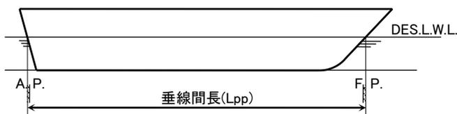
(3) 縦軸推進装置を有する船舶
