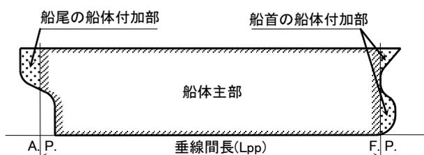
十 付加物 バルジその他上甲板下の船体の外面に取り付けられた構造物をいう。
