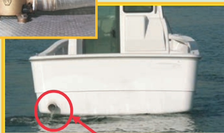
冷却水出口（排気管兼用）
