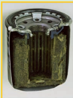
劣化したフィルター
