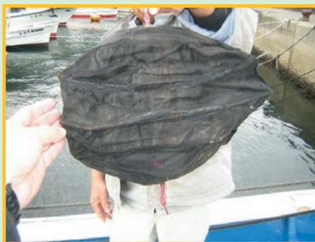
黒色球形形象物 腐食による変形
