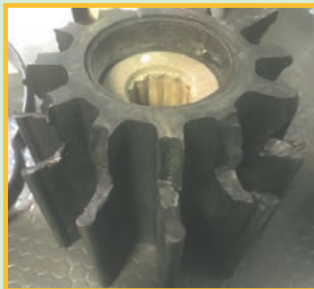
破損したインペラ
