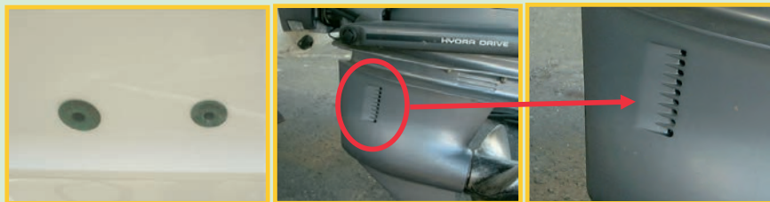
冷却水取入れ口
