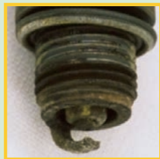
劣化したプラグ
