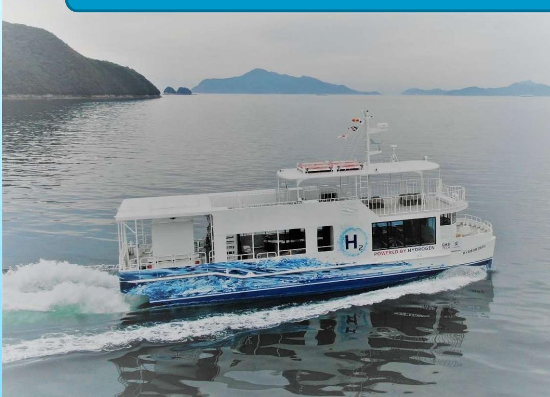
水素と軽油の混焼エンジンを2基搭載した双胴船で、旅客の搭乗を目的とした世界初となる小型旅客船です。ベルギーのCMB社と共同開発したシステムにより、航行時に排出されるCO<sub>2</sub>など地球温暖化の原因となる温室効果ガスの排出量を大幅に削減したエコシップで、これまでのディーゼルエンジンと比較して、最大50%のCO<sub>2</sub>排出削減を実現しています。
